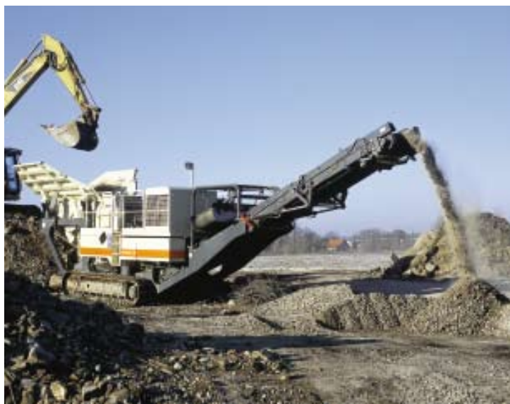
La resistente y larga cinta transportadora principal puede ir equipada con un separador magnético opcional para aplicaciones de reciclaje.
