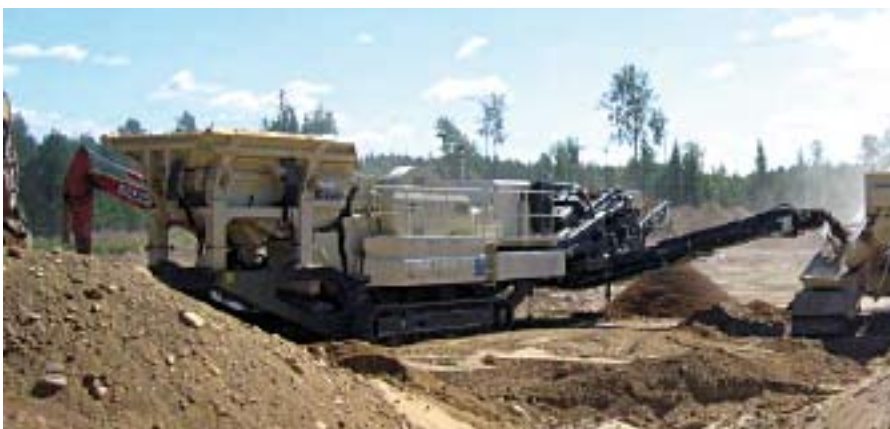
El sistema de control inteligente del IC500 controla automáticamente los procesos y funciona sin operador.
