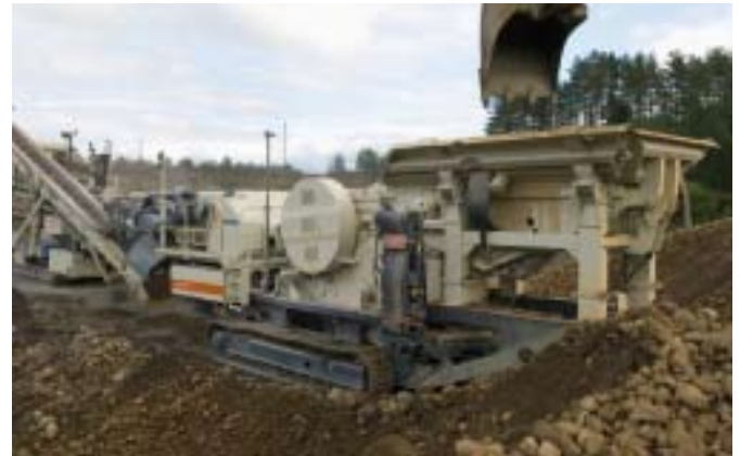
Planta de mandíbulas Lokotrack LT106S con criba desmontable.
