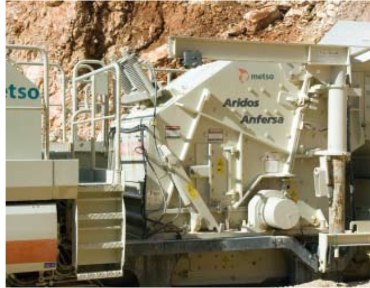
La trituradora por impacto Nordberg NP1213M ha sido diseñada especialmente para la planta trituradora móvil Lokotrack LT1213.
