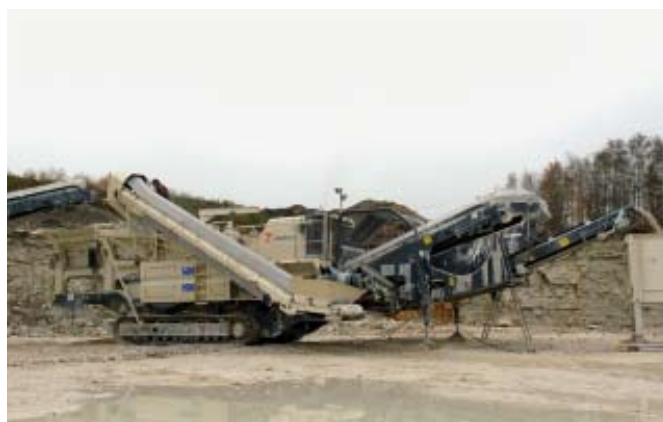
Planta por impacto Lokotrack LT1213S con criba desmontable.
