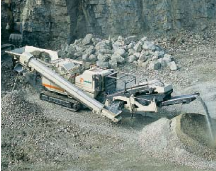
Gracias al controlador inteligente IC500, el funcionamiento autónomo de la Lokotrack LT1110S es perfectamente posible.
