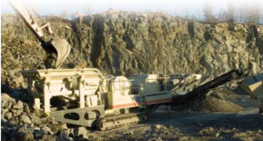
La unidad de cribado puede desconectarse en minutos, permitiendo el uso de la Lokotrack LT106S como una unidad de trituración primaria normal.
