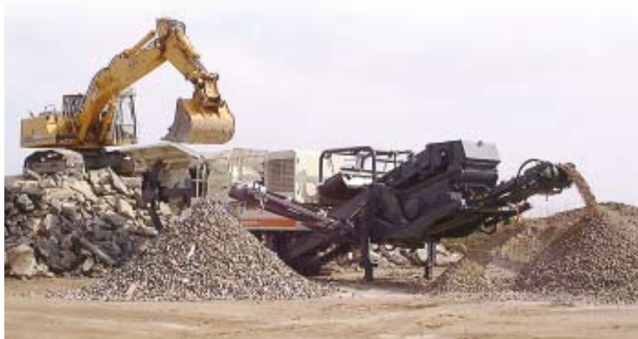
La Lokotrack LT96 triturando hormigón reciclado en Alemania.
