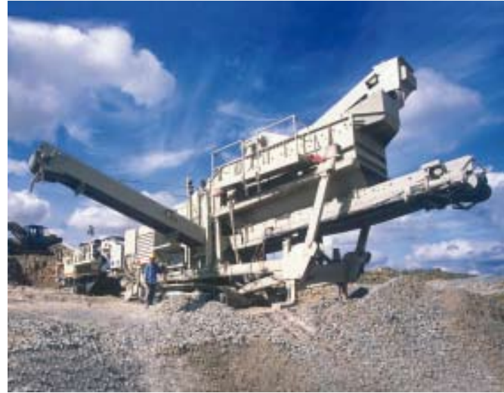
Para la LT1100 pueden elegirse las trituradoras de cono Nordberg GP11M o GP11F.
