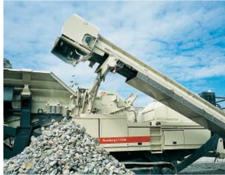
Es posible producir dos productos finales con un funcionamiento de circuito abierto.
