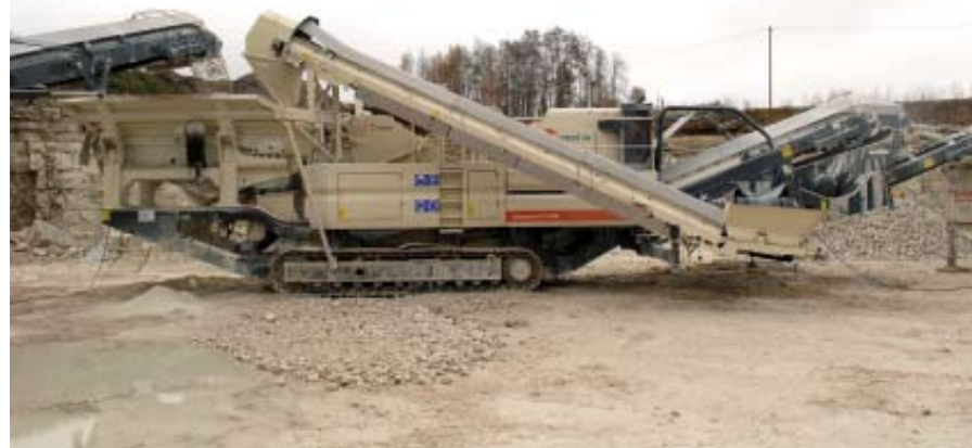
Cuando se utiliza en circuito cerrado, la Lokotrack LT1213S produce un producto final calibrado con exactitud.
