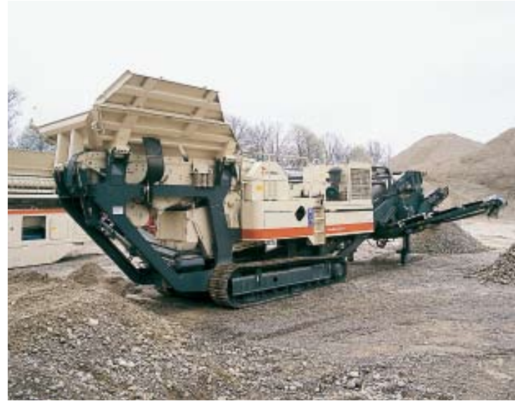
La Lokotrack LT96S admite resistentes tolvas de alimentación de 4 m 3 ó 6 m 3 con acero Hardox.
