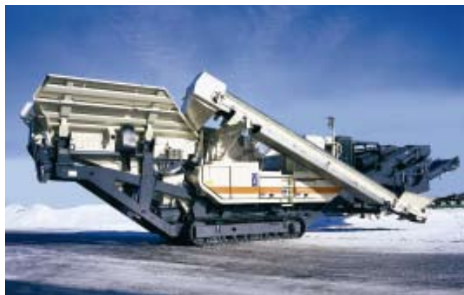
Planta por impacto Lokotrack LT1110S con criba desmontable.
