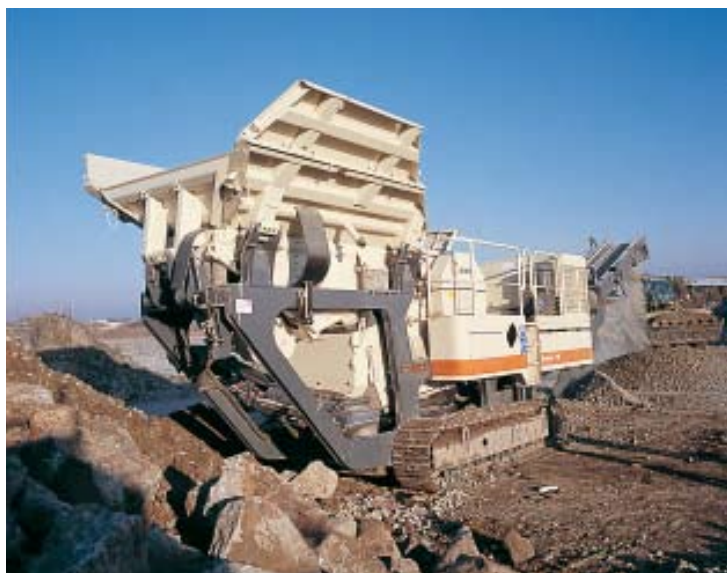
Otra característica única de la Lokotrack LT96 es el mecanismo de bloqueo automático para el alimentador, que acorta el tiempo de preparación necesario para el transporte.
