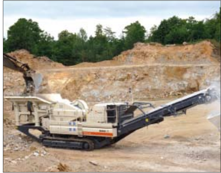
Trituración primaria de áridos extraídos mediante voladura en Polonia con una LT116.
