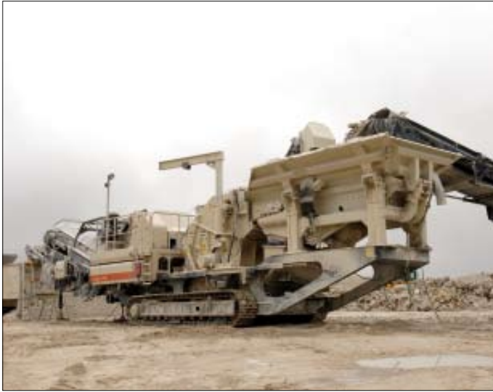
La Lokotrack LT1213S triturando y cribando caliza en Estonia.
