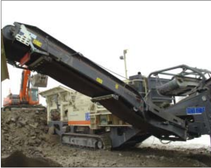
Trituración de material de reciclaje en Finlandia con la LT106S.
