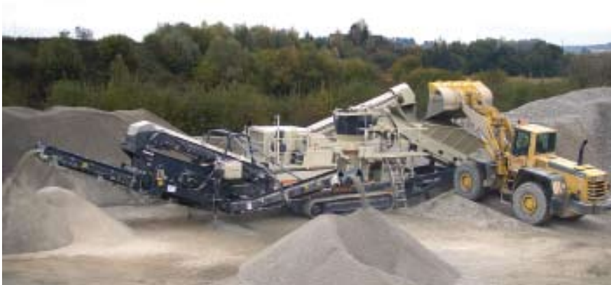
La abertura hidráulica del módulo de cribado LT200HPS permite cambiar de malla fácil y rápidamente.
