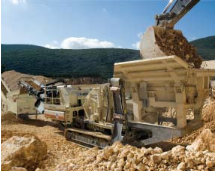
La resistente tolva de alimentación de la LT1213 se fabrica en acero de alta calidad resistente al desgaste.
