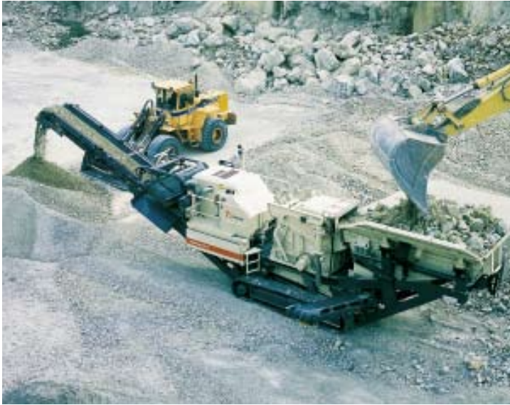
Según la aplicación, la Lokotrack LT1110 puede ser equipada con una tolva de alimentación de 5 m 3 u 8 m 3 .
