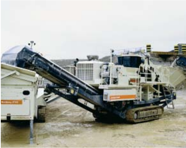
La Lokotrack LT200HP puede ser utilizada fácilmente como planta por impacto o de mandíbulas y con una criba móvil.
