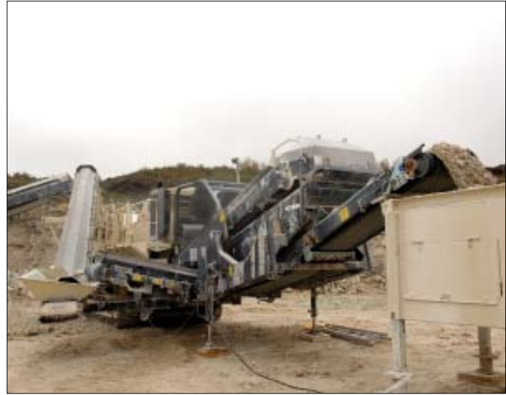
La criba de la Lokotrack LT1213S puede abrirse fácilmente para el mantenimiento y el cambio de la malla de la criba.
