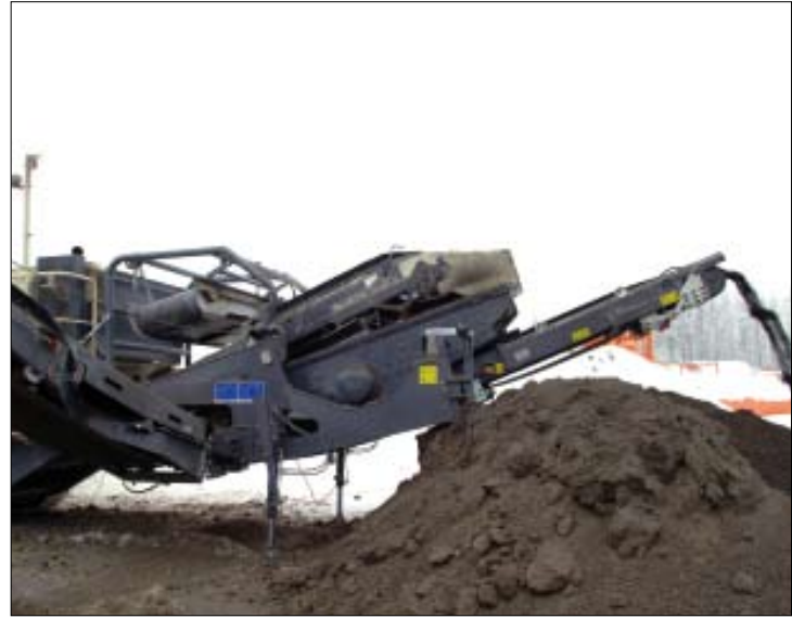
Dos sentidos de rotación posibles en el módulo de cribado de la LT106S.
