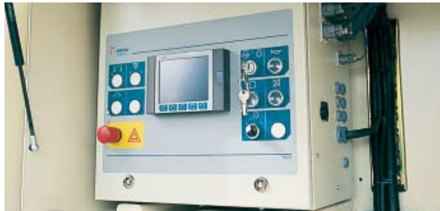
El revolucionario controlador inteligente IC500 controla toda la operación de trituración y proporciona información de trituración en tiempo real acerca de todas las funciones principales.
