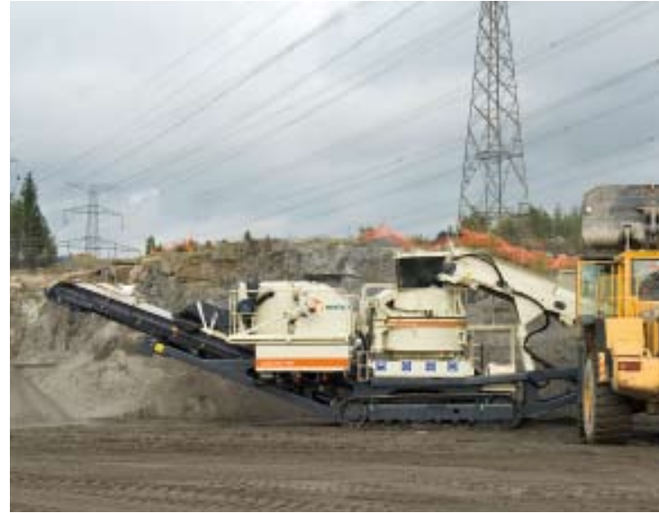
Gracias a la gran tolva de alimentación la LT7150 puede alimentarse por cinta, excavadora o cargadora con ruedas.
