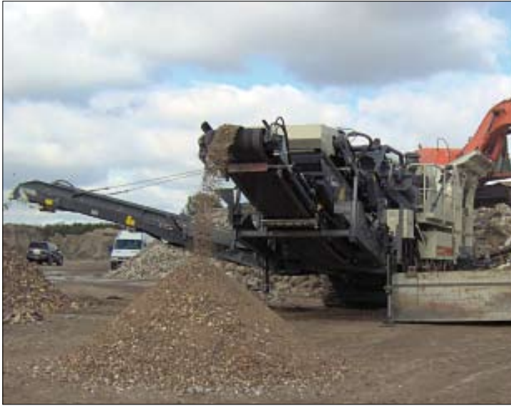
El módulo de cribado de la LT116S puede desmontarse rápidamente y acoplarse a los modelos LT1213 y LT200HP en caso necesario.
