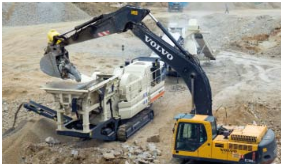
LT116 en un proceso de trituración en dos fases y cribado con una planta de cono LT200HPS.
