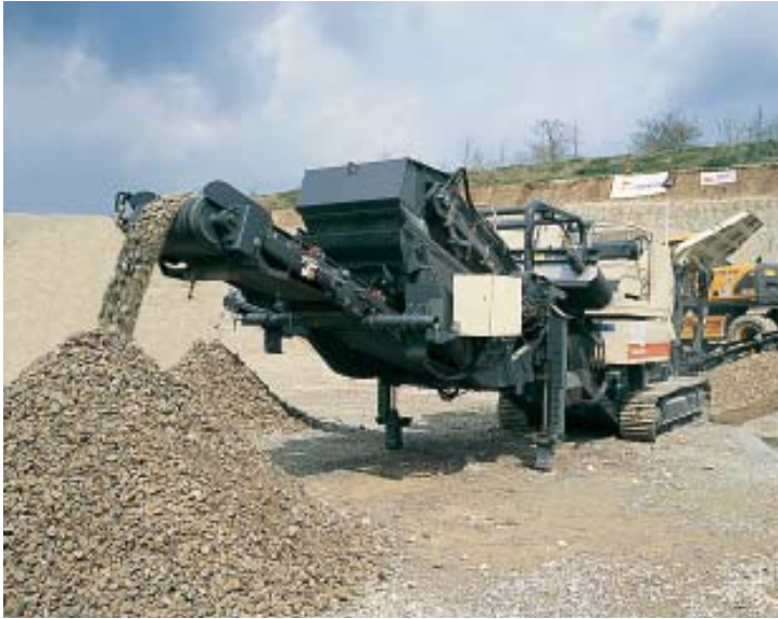
La criba desmontable de la Lokotrack LT96S garantiza una clasificación eficiente de los materiales triturados para obtener productos finales limpios.
