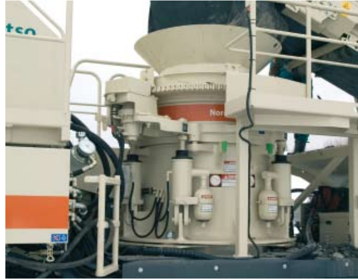
La LT200HP está construida alrededor de la probada y popular trituradora de cono HP200.
