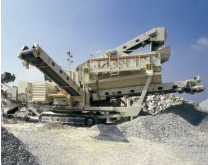
La LT1100 puede ser transportada fácilmente de un emplazamiento a otro como una sola unidad a bordo de un remolque.
