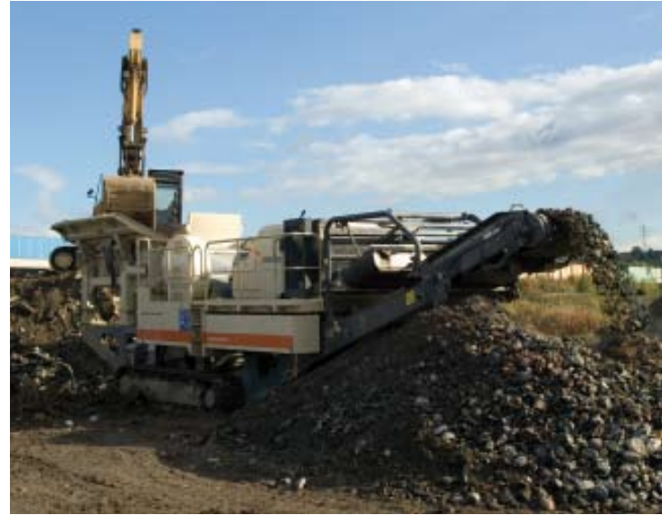
Además de la cinta transportadora estándar, también está disponible una cinta transportadora más larga con plegado hidráulico.
